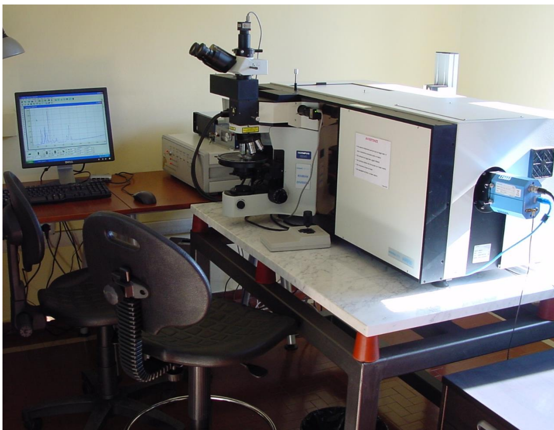
Fig.6 Photograph of the Horiba Jobin Yvon LabRam HRVIS Raman System, at the Centro “G. Scansetti”, Dipartimento di Scienze della Terra, Università di Torino, adopted for CO 2 spectra acquisitions.
