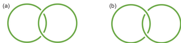
图4 (网络版彩图)两种拓扑位形之比较. (a) 两个互不嵌套的平庸圆, 其缠绕数为0; (b) Hopf链环, 高斯缠绕数为 \pm 1 (参见图5)
