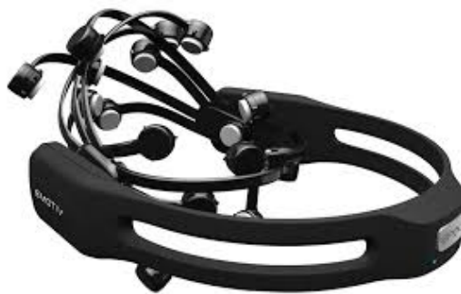
Figura 4: Emotive Epoc + utilizzato per registrare i segnali EEG
