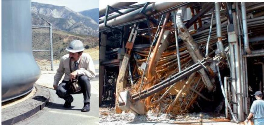
Figura 1. A sinistra, elephant-foot-buckling di un serbatoio durante il terremoto del 17 Gennaio 1994 a Northridge in California [9]; a destra, tubazioni danneggiate durante il terremoto del 17 Agosto 1999 a Tupras in Turchia [fonte: <http://www.enea.it/it/comunicare-la-ricerca/events/tohoku-1lug11/20110701ENEAServa.pdf>]
