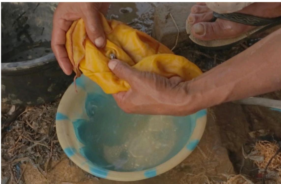
**Immagine 13.** Amalgama d'oro al termine del processo di frantumazione e lavaggio nei cilindri. Sul fondo della bacinella è precipitato il mercurio utilizzato nel processo metallurgico, marzo 2015
