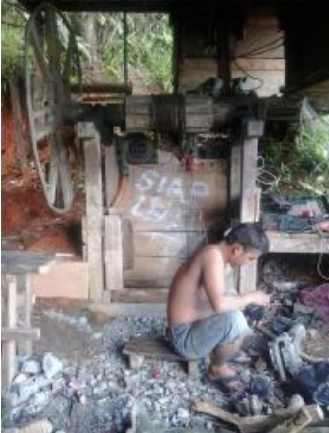
**Immagine 5.** Portale di accesso alla rete sotterranea di cunicoli a Kamp 3, dotato di soffiatore per pompare aria fresca nel sottosuolo e argano per lo spostamento delle sacche e degli attrezzi, aprile 2014
