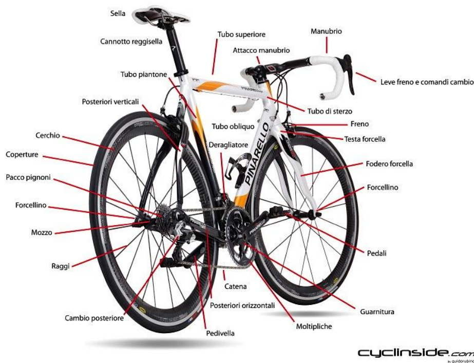
Una bicicletta da corsa di oggi con le sue parti principali ( http://www.cyclinside.com/Bicicletta-da-corsa.html )
