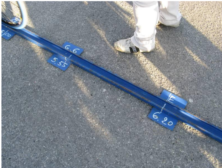
Il tratto di binario/canalina, utilizzato per il controllo delle biciclette di varie categorie, che indica lo sviluppo massimo del rapporto consentito ai ragazzi dell'ultimo anno della categoria Giovanissimi (G 6: m. 5,55) e a quelli della categoria Esordienti (E: m. 6,20)
