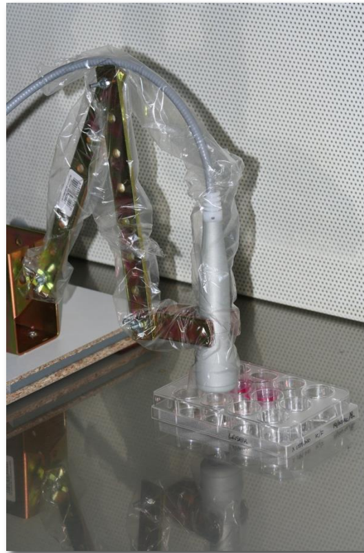
Fig. 11 Manipolo “Onda Piana” su braccio meccanico
