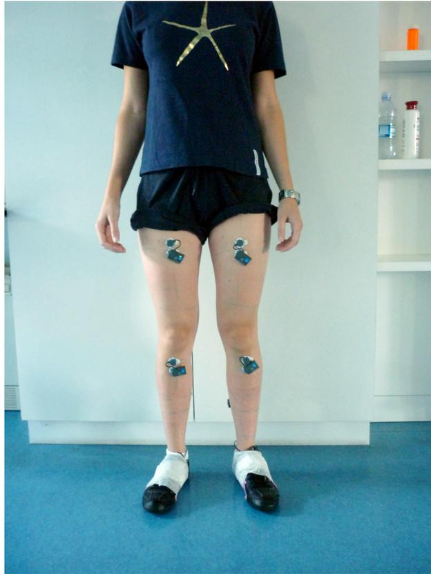
Figura 2.7 - Posizionamento delle sonde-elettrodi a livello dei m. retto femorale e tibiale anteriore.
