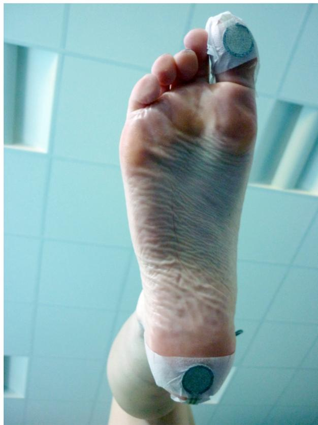
Figura 2.9 - Posizionamento dei foot switch a livello della regione calcaneare plantare e della falange distale del I raggio del piede.
