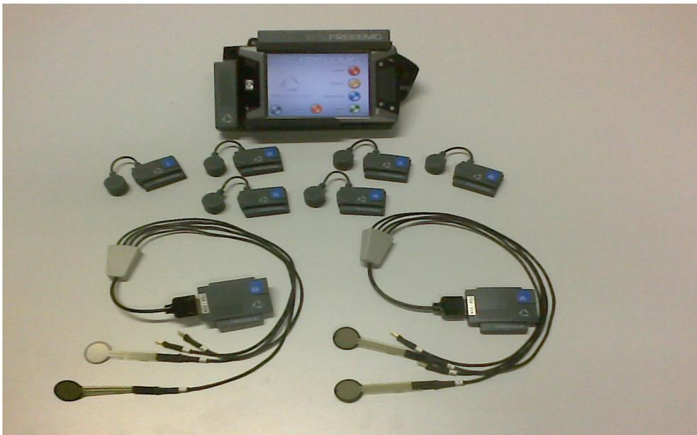
Figura 2.6 - Elettromiografo FREEEMG (BTS Bioengineering, Garbagnate Milanese, MI) dotato di sonde senza fili e sensori di pressione.
