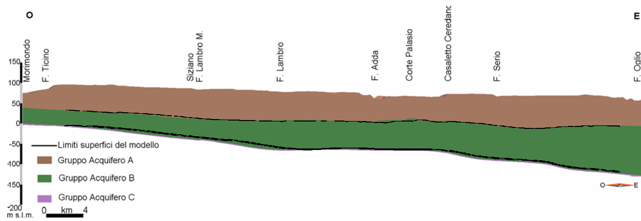
Figura 6.10 – Sezione Ovest-Est j=94, ricostruita in Gocad, relativa al sistema idrogeologico in esame
