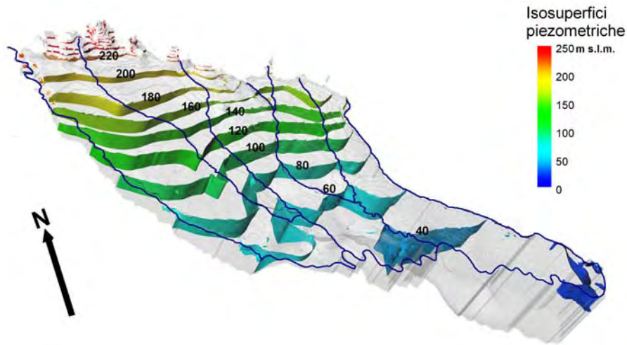
Figura 6.55 – Immagine tridimensionale della piezometria calcolata per il MODELLO 3
