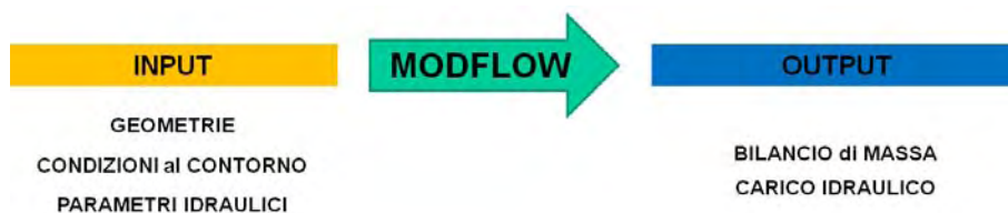
Figura 6.1 – Input e output di MODFLOW
