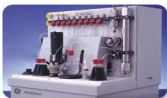
Fig. 8. Modulo automatico TracerLab FX-FN per la marcatura con Fluoro-18 mediante sostituzione nucleofila.
