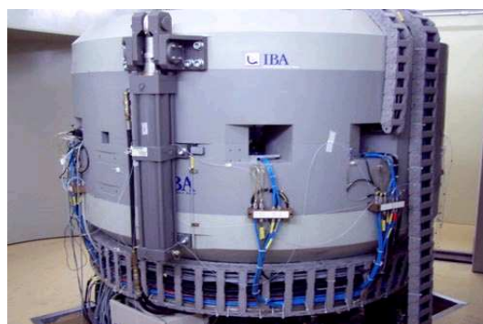
Fig.5: Modello di ciclotrone a 18 MeV (Cyclone 18/9 MeV, IBA)
