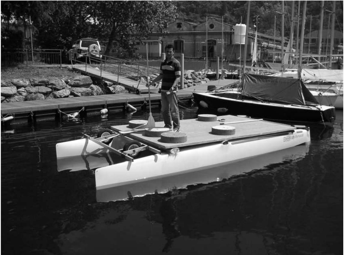
*Fig. 10: Risultato primo collaudo di verifica del pescaggio: come si nota la barca mantiene un buon assetto ed inoltre il pescaggio è minimo.*
