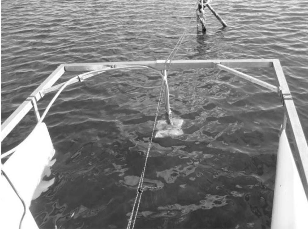
*Fig. 13: particolare dell'ancoraggio per il trasduttore SBP*
