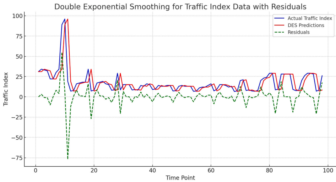
Fig. 8. Forecasting the parameters of the “Traffic index” parameter using the DES method.
